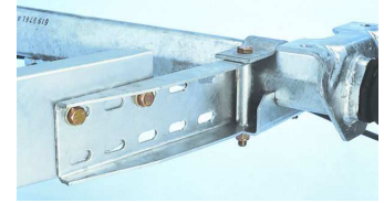
Holmanschluss V- Deichsel Bestellnummer: 267022
