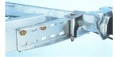
Holmanschluss V- Deichsel Bestellnummer: 249998
